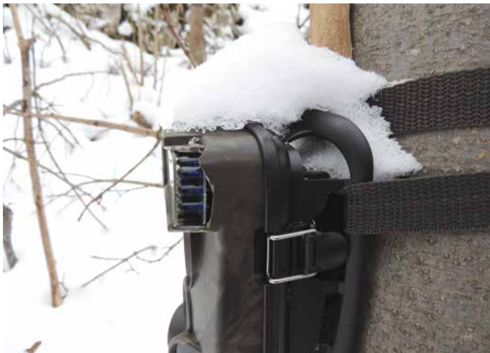
Камера оштећена ледом
